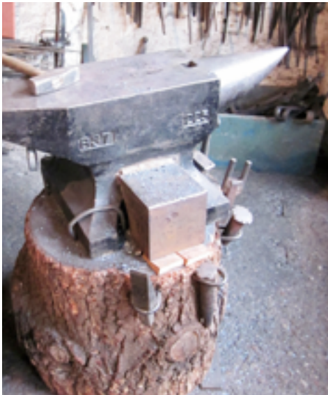
De 'Volvo' onder de aambeelden: het Kohlswa aambeeld met stuikijzer.
