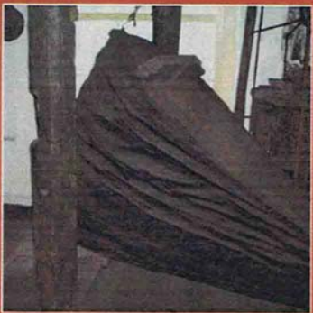
Op de tussenzolder bevinden zich twee oude leren blaasbalgen. Ze zijn schoongemaakt en het leer is bewerkt met vet. Met dank aan Willeke. Op de voorgrond de 'normale' en op de achtergrond de cilinderblaasbalg.
