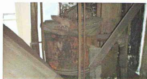
Op de tussenzolder staat een tweede, cilindervormige blaasbalg, ooit om het kleine vuur aan te jagen.
