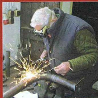
Vrijwilliger Smit last de buizen voor de luchttoevoer van het zjuiver aan elkaar
